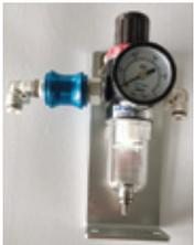
È composto da un filtro dell'aria (separatore d'acqua e filtro dell'aria) e da un riduttore di pressione (valvola di regolazione della pressione). La funzione principale del filtro dell'aria (filtro dell'aria di separazione dell'acqua) è quella di pulire la fonte di aria inquinata, filtrare l'acqua e le impurità nell'aria compressa e impedire che l'acqua e le impurità entrino nell'apparecchiatura con il gas. La precisione di filtrazione è di 40µm.
