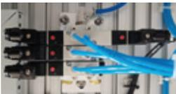
Viene utilizzato per controllare attuatori pneumatici come cilindri pneumatici, pinze robot e ventose.
