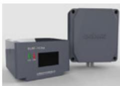
Letture RFID di livello industriale che funziona a 13,56 MHz e supporta il protocollo ISO-15693. Il lettore è alimentato a DC24V e dispone di un display a cristalli liquidi a LED per visualizzare informazioni sulla lettura della carta RFID. Il modulo RFID fornisce due protocolli di comunicazione standard: MODBUS\_TCP o MODBUS\_RTU.
